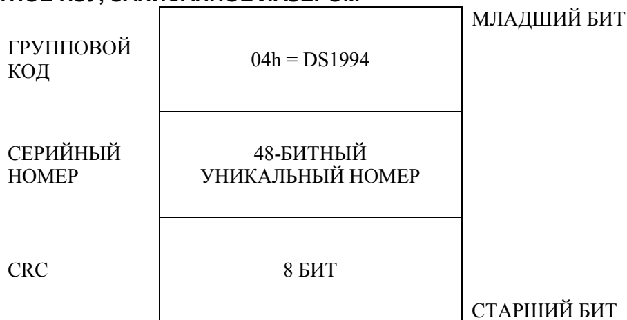
Рис. 2. 64-БИТНОЕ ПЗУ, ЗАПИСАННОЕ ЛАЗЕРОМ
